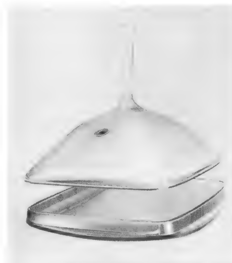
Bild 2. Einzelteile des Glaskolbens einer Röhre AW 59-90: Schirmwanne, Konus und Hals
