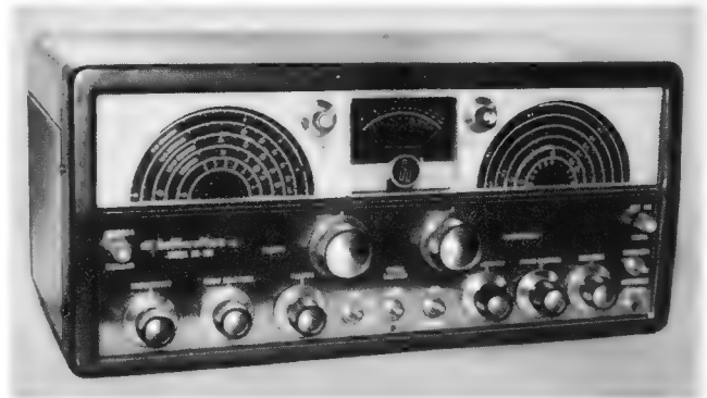
Bild 1a. Die Frontansicht des Gerätes SX 100 der amerikanischen Firma Hallicrafters
